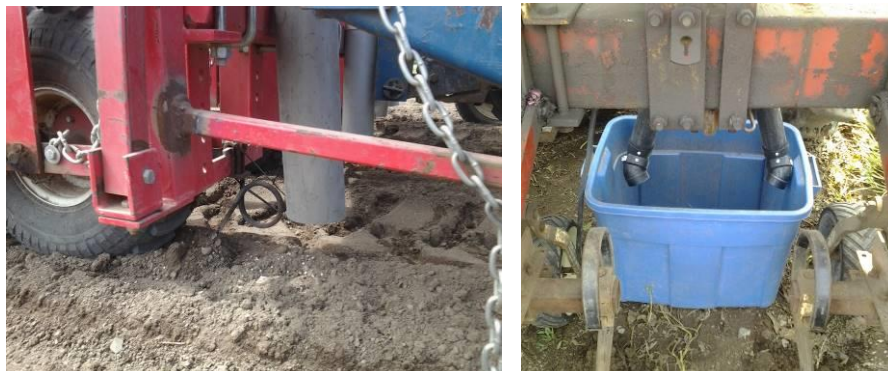
Figure 3 : Exemple de dispositif de placement de l'engrais : tuyau simple utilisé à la plantation (a) deux tuyaux permettant de fractionner de chaque côté du rang (b).
