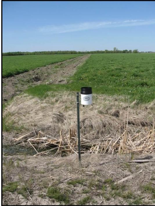
Figure A.9 - Pluviomètre installé sur le site Berna au cours du printemps 2010 (Photo : Mikael Guillou).
