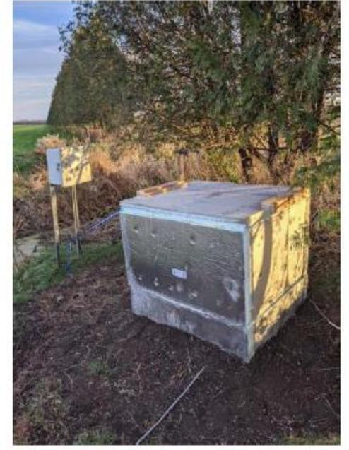
Figure 7 échantillonneur ISCO (7.1); puit d'accès au drain (7.2); boîte isolée et chauffée (7.3)
