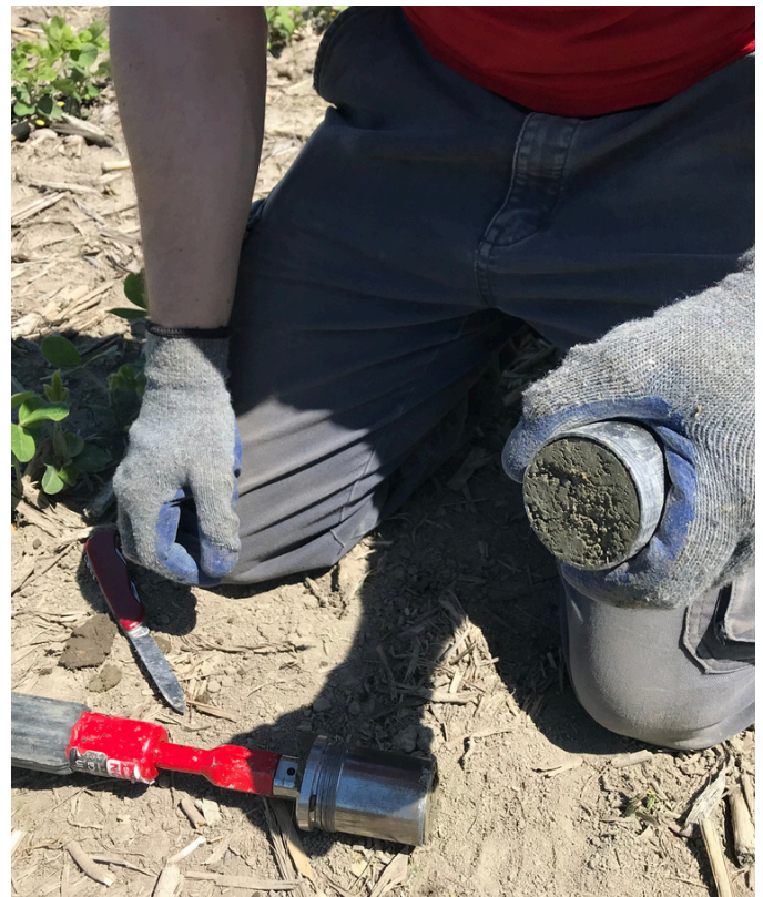
[E] Un cylindre métallique contenant un volume précis de sol est enfoncé verticalement afin de mesurer la densité apparente du sol entre 0 et 20 cm et entre 20 à 50 cm de profondeur.
