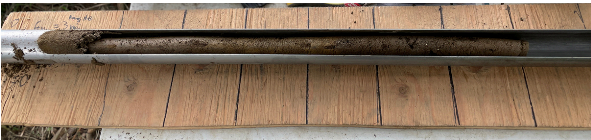
[C] Prélèvement d'une carotte de sol jusqu'à 50 cm de profondeur. Trois carottes de sol sont mélangées pour créer un échantillon composite afin de pallier la variabilité spatiale dans le carbone du sol.
