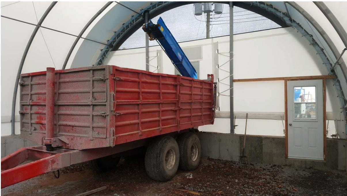
Figure A8. Convoyeur déposant le compost dans une benne mobile sous le dôme
