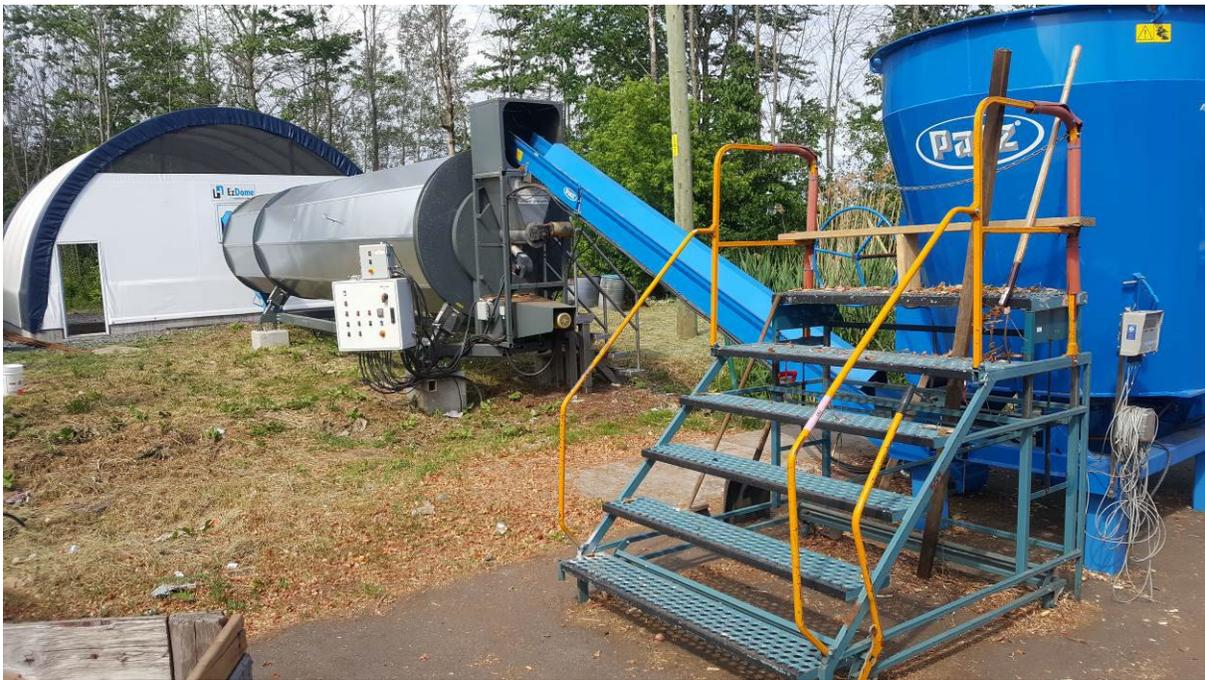
Figure A6. De droite à gauche : mélangeur, convoyeur, composteur et dôme
