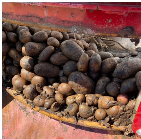
Photos 4. Pommes de terre lacérées mécaniquement sortant du mélangeur (insuffisamment lacérées)
