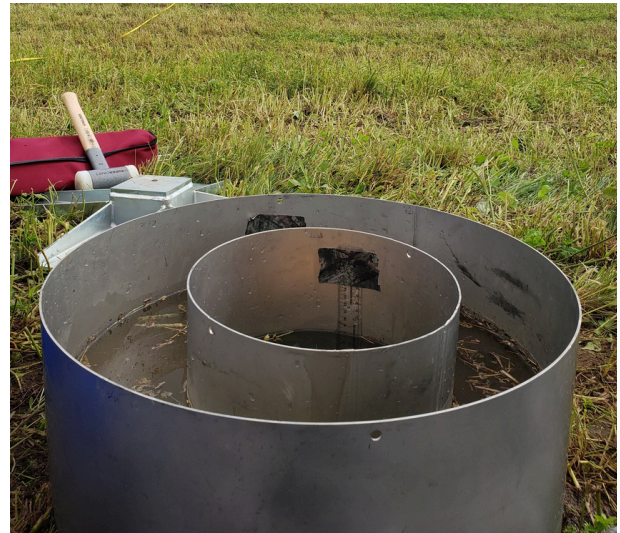
[F] Des infiltromètres à double paroi permettent de mesurer la conductivité hydraulique à saturation du sol, c'est-à-dire l'infiltration de l'eau lorsque les pores du sol sont remplis d'eau.
