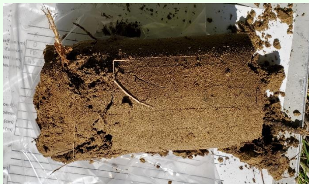
Figure 7. Carotte de 15 cm de long et de 8 cm de diamètre prélevés à l'aide d'une sonde volumétrique
