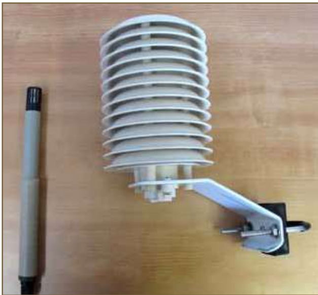
FIGURE 6. SONDE DE MESURE DE LA TEMPÉRATURE ET DE L'HUMIDITÉ RELATIVE DE L'AIR (RETIRÉE DE SON ABRI)
