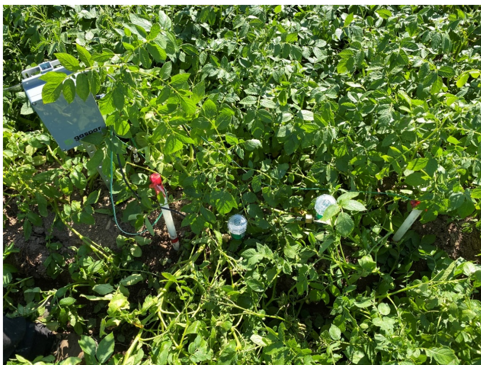
Figure 2. Installation des tensiomètres et des sondes Watermark sur le site Valupierre en 2020
