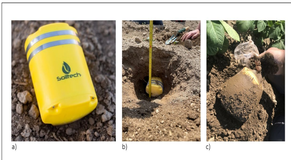
Figure 5. Installation de la sonde Soiltech (a) sur le site Valupierre en 2021 en juin 2021 (b) et lors de la réinstallation en juillet 2021 (c)
