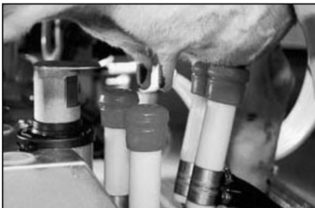
Figure 11. Système de repérage des trayons du robot Bou-Matic, identique au système du robot Astronaut de Lely
