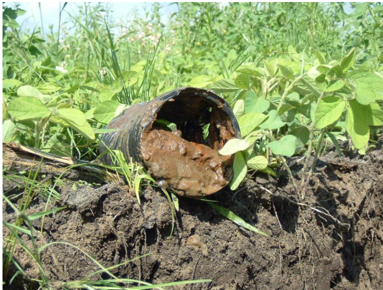
Figure 7 : Une coupe transversale du collecteur « B », démontrant la sédimentation des particules fines qui se sont accumulées dans le tuyau, surtout aux endroits des contrepentes.
